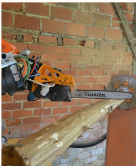
Robot usinant un tronçon © Manufacture du châtaignier
